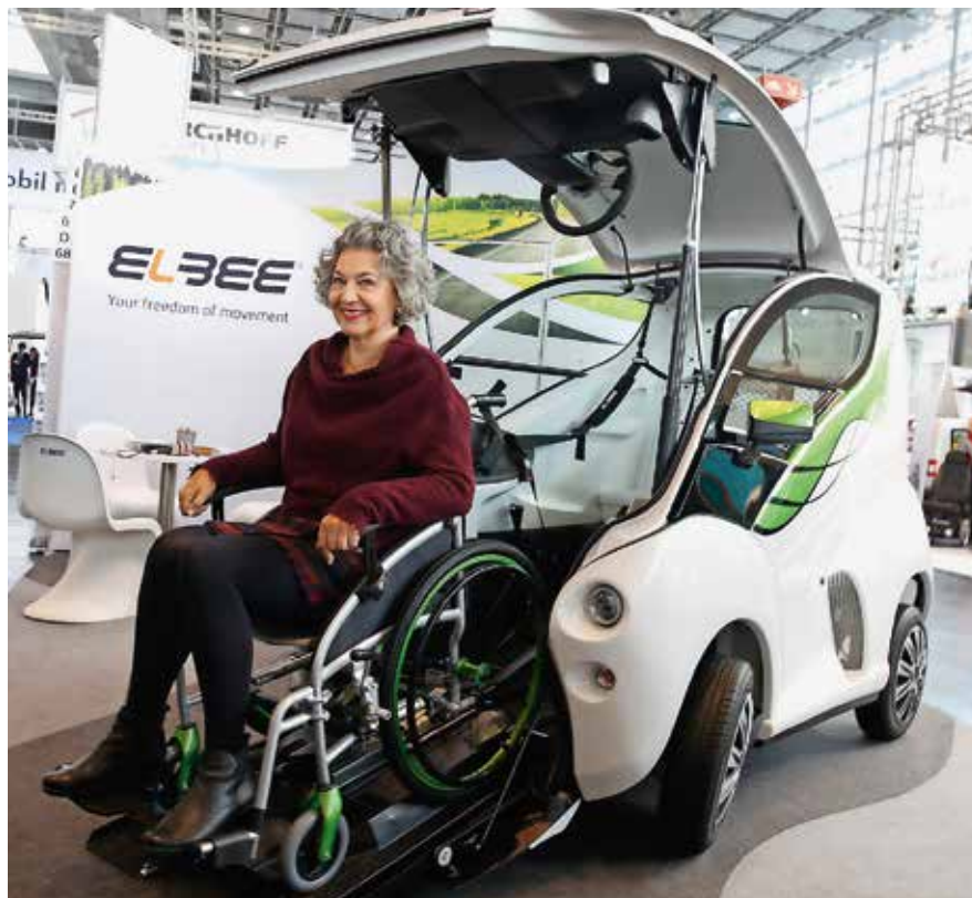
Der tschechische Hersteller ZLKL stellte seinen ELBEE vor: Einen kleinen Stadtflyer, eine Art Quad mit geschlossener Fahrerkabine, der Rollstuhlfahrern in Städten Bequemlichkeit und Beweglichkeit bietet.
