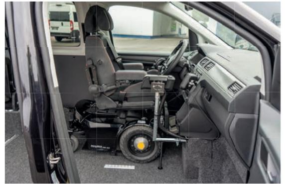
Direkt bis hinter das Lenkrad fahren
