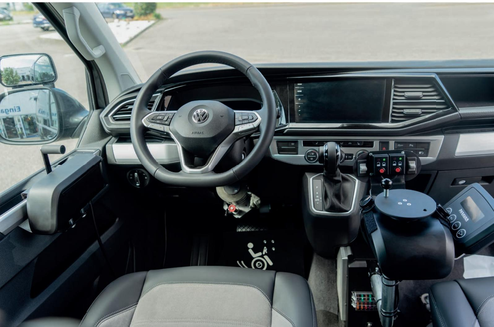
Links: Gas-Brems-Schieber / Rechts: Mini-Lenkrad und Check-Control
