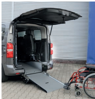
Bei ausgeklappter Rampe lässt sich das Fahrzeug bequem mit dem Rollstuhl befahren.
