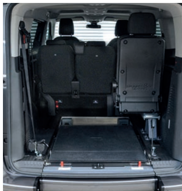
Die eingeklappte EASYFLEX Rampe ermöglicht die volle Nutzung des Kofferraums.
