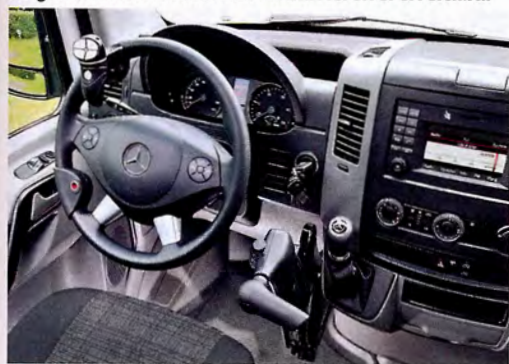
FAHREN ohne Fußsinsatz. Bedieneinheit nach vorn drücken: Bremsen; nach rechts drehen: Gas – ganz easy!
