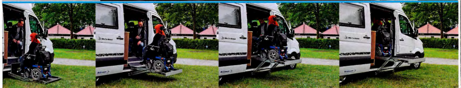
MENTALENT In weniger als einer Minute hievt der AMF-K90-Kassettenlift Sabine hinauf ins Mobil. Die Hebebühne könnte bis zu 300 Kilo tragen
