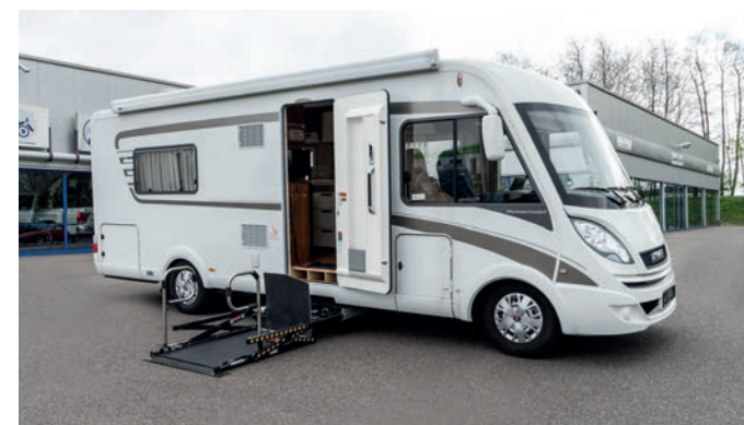
Barrierefreier Zugang mit Hub-Hebelift
