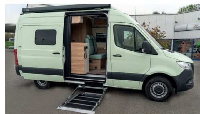
Kassettenlift bei diversen Fahrzeugmodellen nachrüstbar
