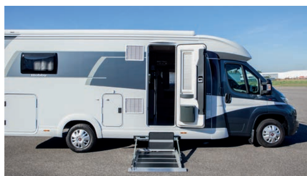
Kassettenlift zum einfachen Ein- & Ausstieg mit Rolli
