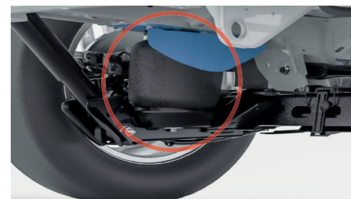
Nachrüstbare Luftfahrwerke : Mehr Bodenfreiheit, Komfort, bei unebenen Böden Ausnivellierung des Fahrzeuges, für Hinterachse und/oder Vorderachse.
