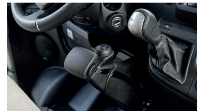
Gasgeben, Bremsen und Bedienen von z.B. Blinker, Licht etc. ganz leicht über ein Handgerät
