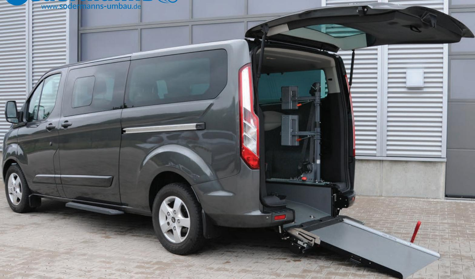
Bei ausgeklappter Rampe lässt sich das Fahrzeug bequem mit dem Rollstuhl befahren
